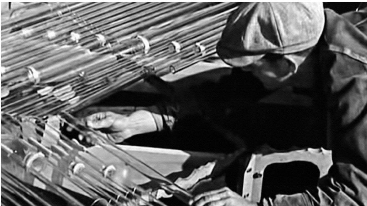
**Figura 57.** Operario colocando la banda elástica entre los tubos Pyrex. Fuente: <https://bit.ly/30JPuWR>.
