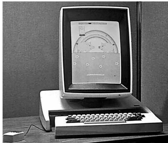
Figura 1. Computadora Xerox Alto II, creada dentro del centro de investigación de Xerox Palo Alto Research Center (PARC). Fue una de las computadoras más innovadoras existentes en su época (1973). Contaba con un monitor vertical, el primer ratón y el primer sistema operativo de interfase gráfica (GUI, por sus siglas en inglés). Xerox prefirió apostar recursos a sus productos de fotocopiado y dejó atrás este proyecto. Esta máquina fue la que inspiró a Steve Jobs en la creación de Lisa, que utilizaba también un sistema operativo gráfico, ratón y una por primera vez un sistema de impresión WISIWIC (What you see is what you get) que permitía imprimir tal cual lo que se veía en el monitor.
