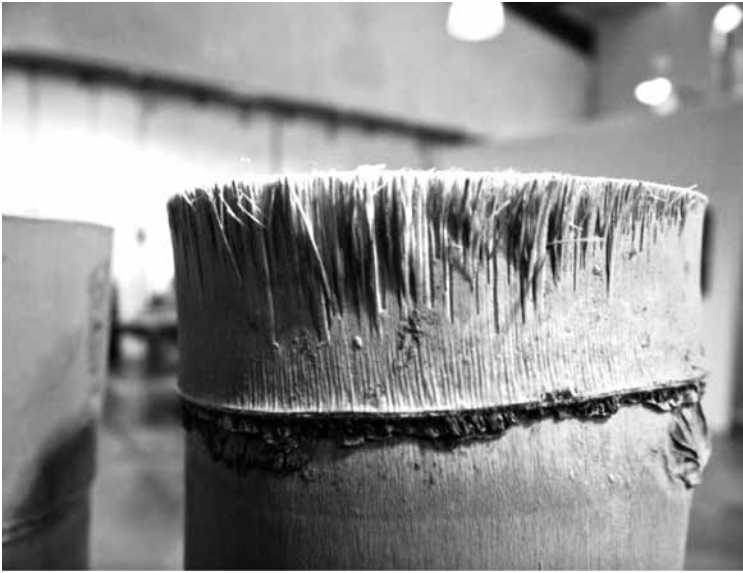
Figura 5. Respuesta del bambú al corte con sierra circular y sierra cinta. Fotografía: José Luis Gutiérrez.
