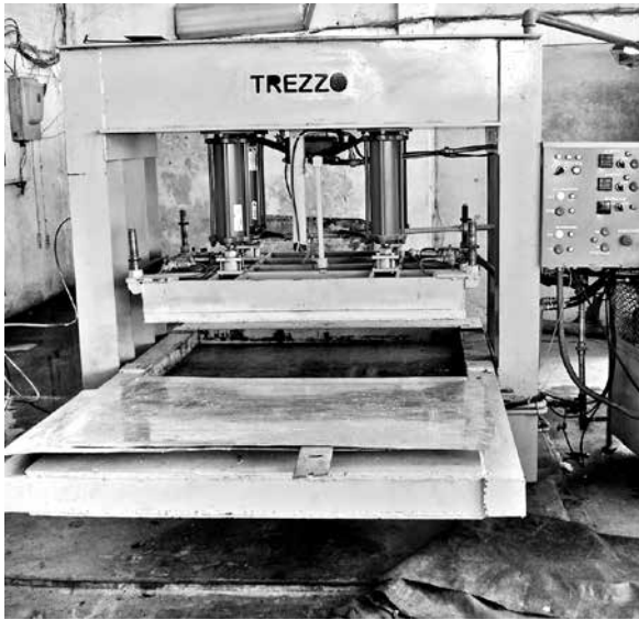
Figura 12. Prensa para elaboración de tableros de bambú. Fuente: José Luis Gutiérrez.
