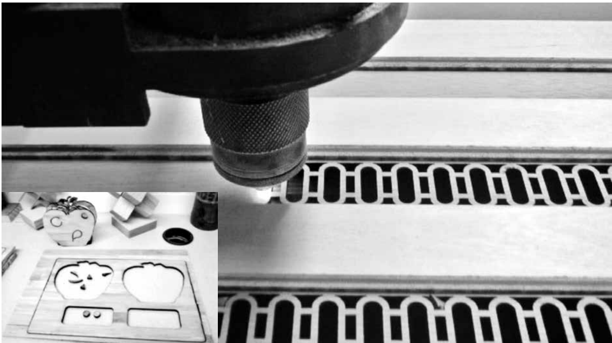
Figura 10. Corte láser en madera y bambú. Fuente: https://maderame.com , y José Luis Gutiérrez.
