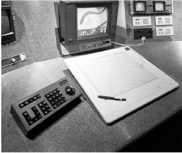
Figura 5. Equipo "Paintbox" de la marca Quantel. Tomada del folleto promocional del Centro de Post-Producción Qualli (1997-1998) que ofrecía servicios de animación y pintado electrónico con este equipo; en la imagen se puede apreciar, en el lado izquierdo, una grabadora digital Abekas con la cual se podía animar cuadro por cuadro.
