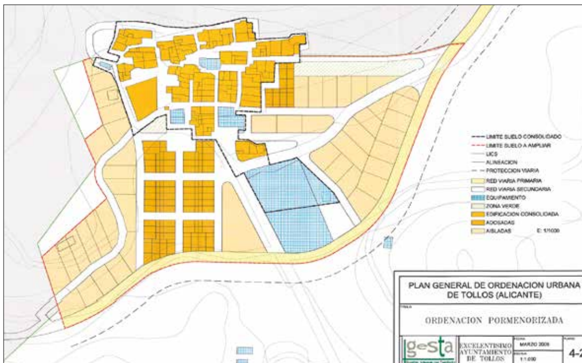
Figura 24. Propuesta final: en la ampliación del casco urbano se mantiene la tipología vernácula (ajustada al parcelario tradicional) y las proporciones de las manzanas, mientras la periferia se destina a viviendas aisladas en parcela, insertas en el paisaje agrario. Fuente: Elaboración propia.
